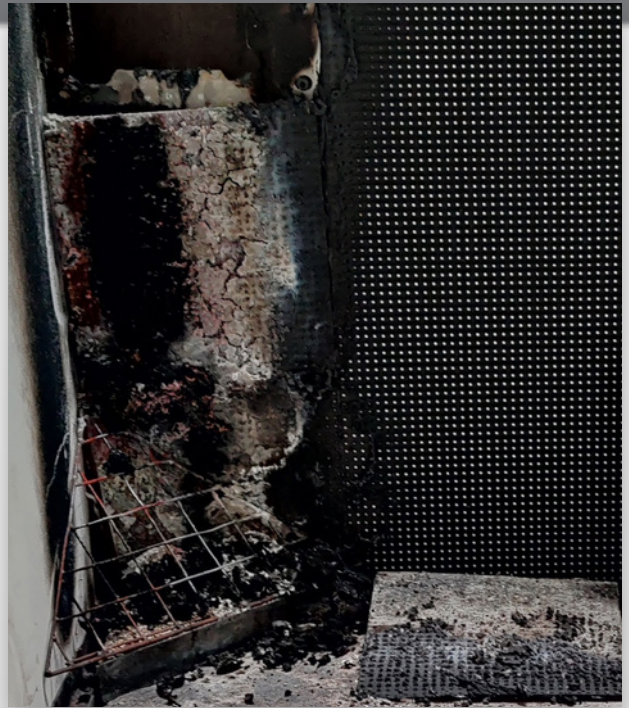
Bild: handelsüblicher LED-Screen nach Brandversuch (SBI)
